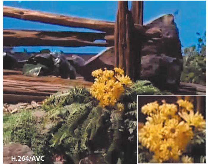
Die Tempete-Sequenz in CIF mit 15 Bildern/s jeweils mit 128 kBit/s; es ist dabei zu erkennen, dass H.264/AVC bei der gewählten Bitrate die Details deutlich klarer darstellt als MPEG-4.
