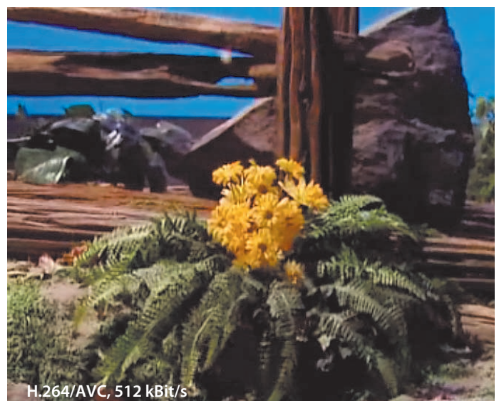
Tempete CIF mit 30 Bildern/s: H.264/AVC erreicht bereits bei 512 kBit/s etwa die gleiche visuelle Qualität wie MPEG-4 mit etwa 1 MBit/s.
