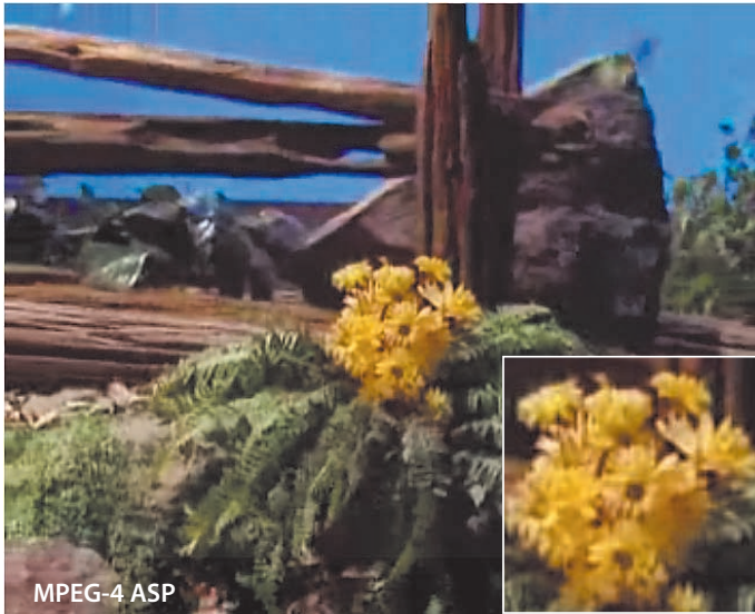
Die Tempete-Sequenz in CIF mit 15 Bildern/s jeweils mit 128 kBit/s; es ist dabei zu erkennen, dass H.264/AVC bei der gewählten Bitrate die Details deutlich klarer darstellt als MPEG-4.
